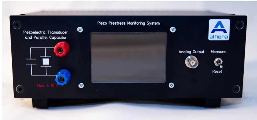
Abbildung 1: ATHENA-Vorspannelektronik mit Anschlüssen für den Ultraschallkonverter nebst Parallelkapazität, analogem Signaloutput und Kippschalter zur Bedienung sowie Farbdisplay zur Anzeige aktueller Messwerte
